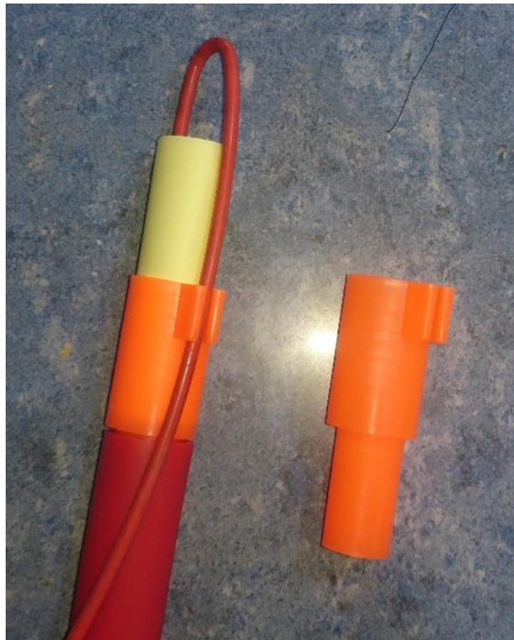
**El SOPEX se utiliza para posicionar al booster con la misma manguera de carga de emulsión en el fondo del pozo. Al inyectar la emulsión, el SOPEX se separa de la manguera.**
